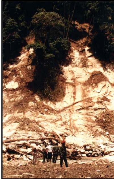
FOTO 3. Típicos flujos superficiales de suelo residual y vegetación, dejando la roca in situ descubierta.
