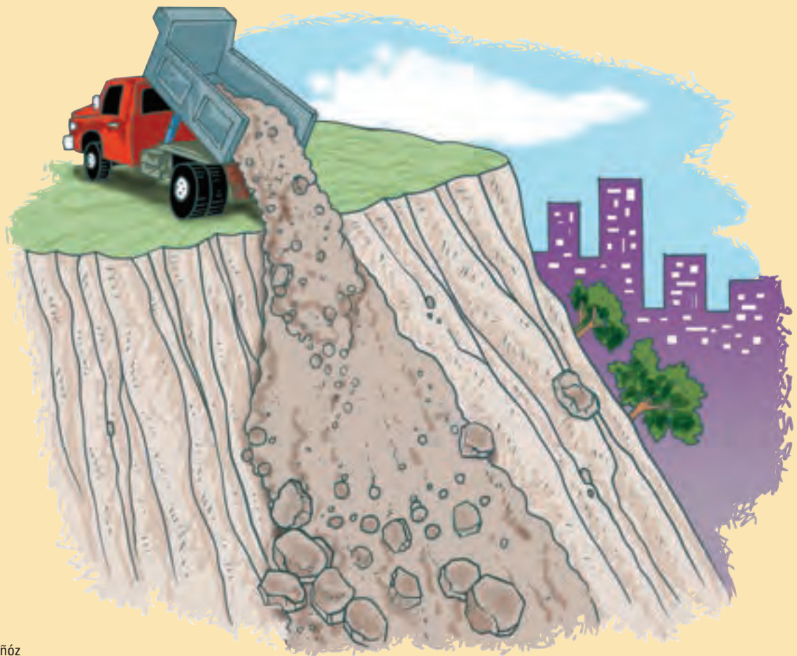
Figura 36 El bote de material sobre una ladera genera problemas de estabilidad y ocasiona graves problemas ambientales
