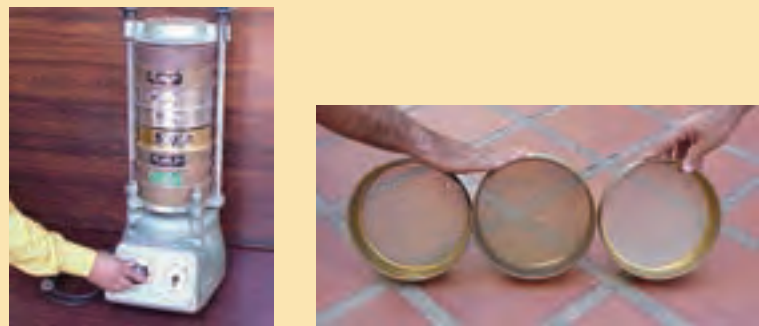
Figura 2 Equipo con tamices para ensayos de granulometría y detalle de abertura de tamices # 4, # 40 y # 200
