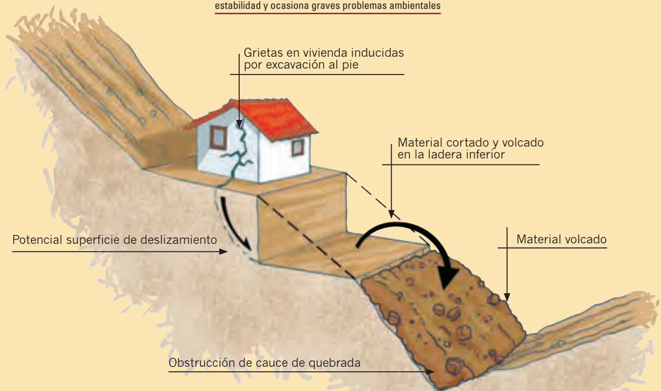
Figura 35 El bote de material sobre una ladera genera problemas de estabilidad y ocasiona graves problemas ambientales
