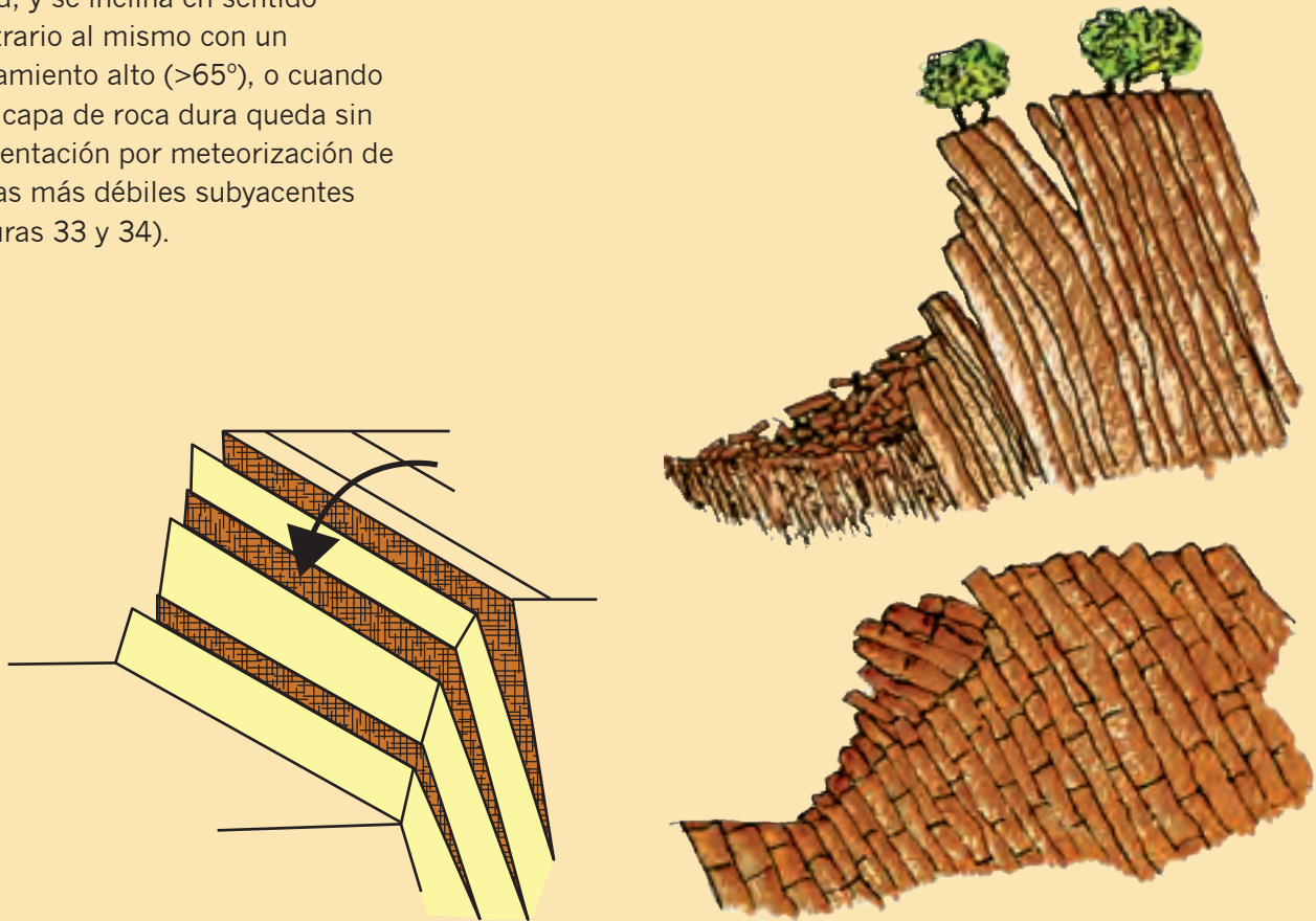
Figura 34 Ejemplos de falla por volcamiento
