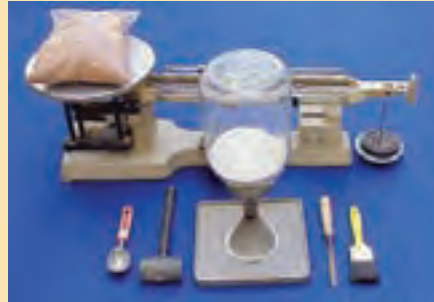
Figura 53 Equipo para la determinación de densidades in situ , mediante el cono de arena
