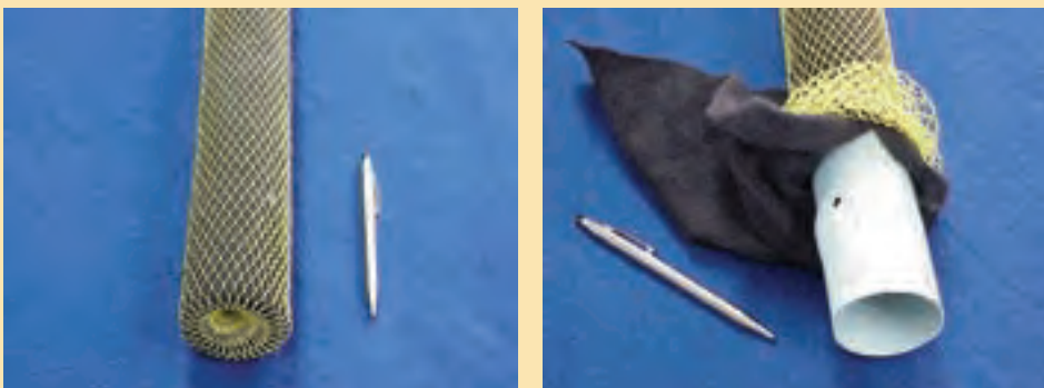
Figura 45 Vista general y detalles de tubo plástico perforado de 2" de diámetro, recubierto con geotextil y malla, utilizado en perforaciones horizontales
