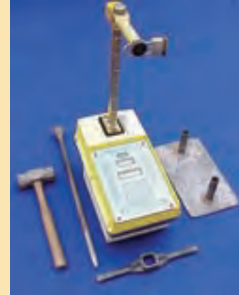
Figura 54 Densímetro nuclear para determinación de densidades y humedades en sitio
