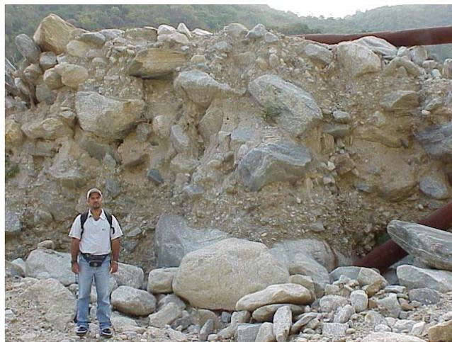
Figura 10. Detalle de la foto anterior mostrando bloques de roca en una matriz gravo-arenosa. Quebrada San Julián.
